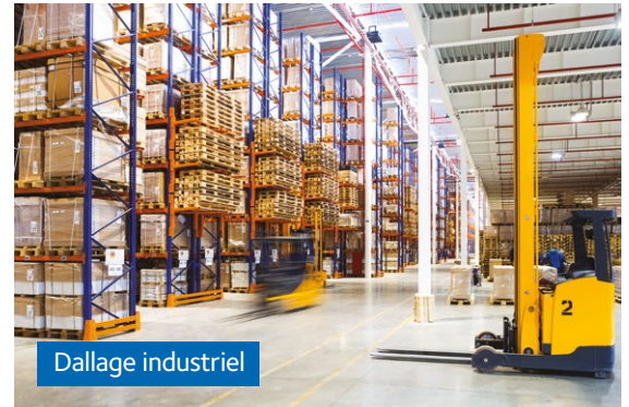
2,0 kg/m 3 , jusqu'à 6 tonnes/essieu sur 150 mm
